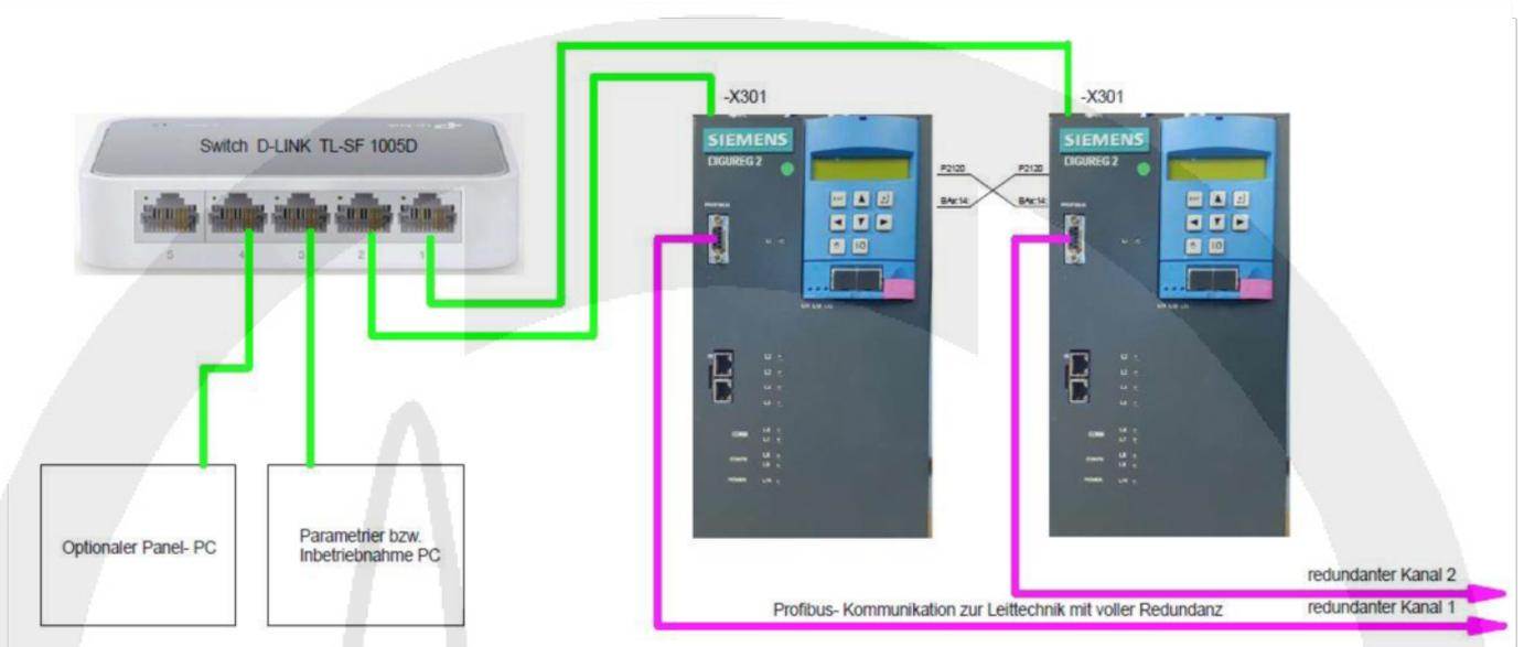
Nachfolgende Skizze zeigt eine redundante Struktur mit Profibus- Ankopplung an die LT sowie die prinzipiell dafür notwendigen Verbindungen zwischen beiden Geräten. Da die beiden Geräte jedoch über eine Busleitung gesteuert werden, ist nur eine 50%ige Redundanz gegeben, d.h. fällt diese Bus- Zuleitung von der Leittechnik aus, sind beide Kanäle nicht mehr verfügbar.
