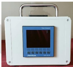
Leistungsmessgerät mit Janitza UMG 96-PA
