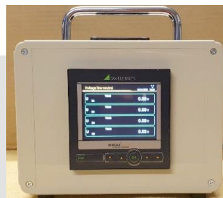
Leistungsmessgerät mit Metrawatt AM1000
