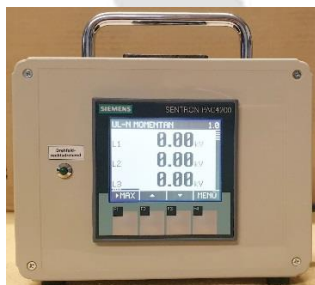
Leistungsmessgerät mit Siemens PAC4200
